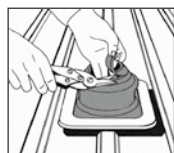
1. Couper le manchon Dektite® au diamètre du conduit.
