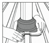
4. Déformer le Dektite® à la forme exacte du profilé
