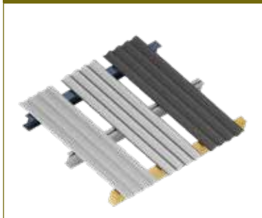
Couverture double peau avec système de joint debout | voir page 48
