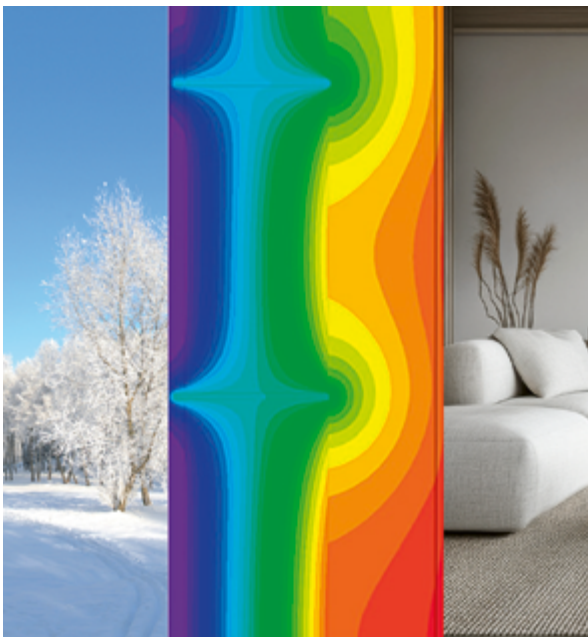
Abbildung 1 Ausgeprägte Wärmebrücke bei Aluminiumkonsolen
