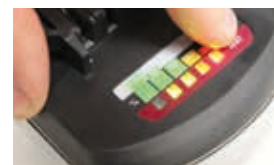
L'indicatore luminoso mostra lo stato di carica della batteria
