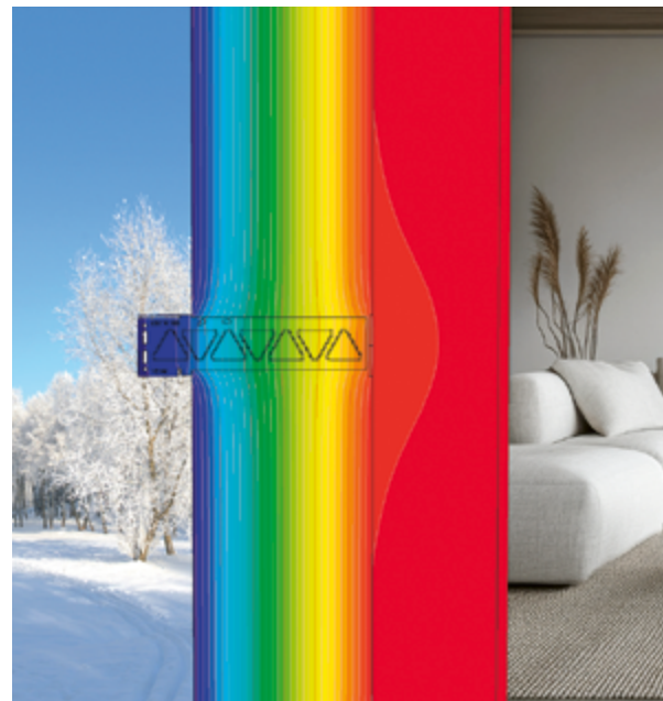
Abbildung 2 Minimale Wärmebrücke bei CROSSFIX®
