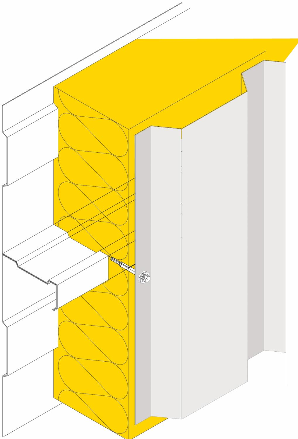
Distanzschrauben und Wandkassetten-System ISOVER WS
